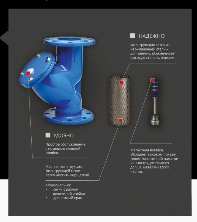
Предназначены для установки перед регулирующей арматурой, теплообменниками, расходомерами, насосами и другими устройствами с повышенными требованиями к чистоте проходящей через них рабочей среды.
