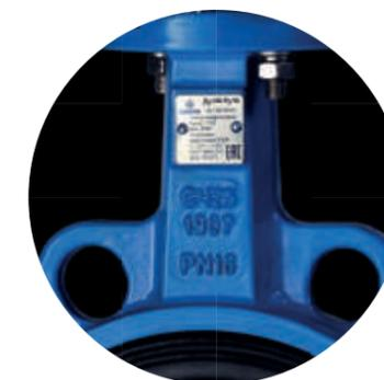
Оригинальные продукты GROSS согласно ГОСТ 4666-2015 на корпусе имеют следующие маркировки: товарный знак, материал корпуса, DN, PN, стрелка направления подачи рабочей среды. На шильде информация дополняется типом материала рабочего органа, седлового уплотнения, датой изготовления.
