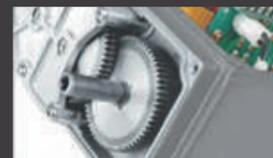
Редукторные шестеренки изготовлены из хромированной стали. Зубчики закалены – выдерживают большую нагрузку в моменте, и обеспечивают длительную эксплуатацию.
