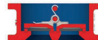
Клапан должен быть установлен в соответствии с направлением стрелки, показывающей направление потока рабочей среды, указанной на корпусе клапана.
