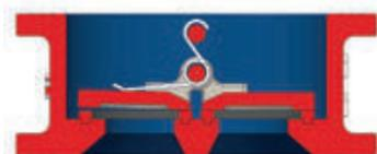
**Направление стрелки на корпусе клапана должно совпадать с направлением движения среды.**
